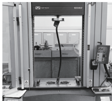
▲カーボンシャフトの破断試験
