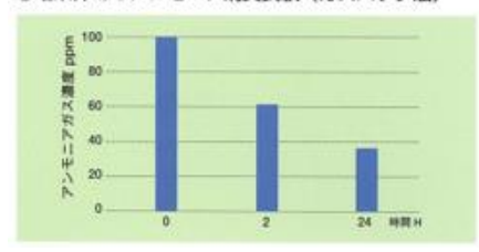
②暗条件でのアンモニア消臭試験 (ガスバック法)
