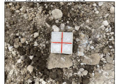
K32 境界点 コンクリート杭
